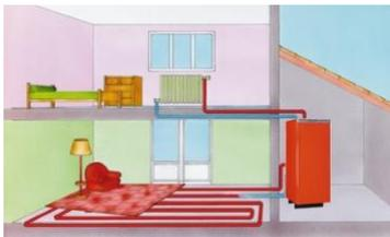
Duotherm : plancher chauffant + circuit radiateur
