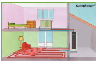
Alimentation directe d'un plancher chauffant et de radiateurs avec une chaudière fioul PERGE Optitherm avec Duotherm
