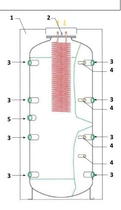
Pression max d'exercice: - ballon 3 bar / 95°C - serpentin 12 bar / 95°C
