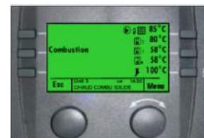
Le tableau de commande affiche en permanence l'état de la chaudière (arrêt, porte ouverte, combustion, modulation, fin de combustion) ainsi que les différentes températures (fumées, haute, milieu et basse du ballon tampon, chaudière). La pompe de recyclage est pilotée en fonction de la température de la chaudière, de la température des fumées et de la température du ballon tampon.
