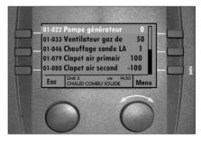
Possibilité de tester les différents éléments de la chaudière.
