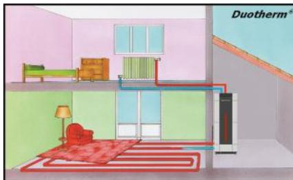
*Alimentation directe d'un plancher chauffant et de radiateurs avec une chaudière fioul PERGE OptiCondens avec Duotherm*
