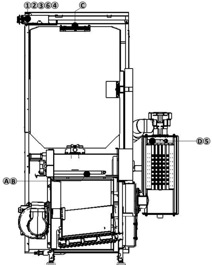
**1 – Thermostat de réglage (0-90°C) :** Le bulbe doit être enfoncé de 240 à 260 mm. depuis la façade dans le doigt de gant A.
