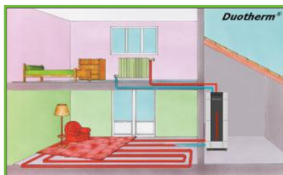
Alimentation directe d'un plancher chauffant et de radiateurs avec une chaudière fioul PERGE Optitherm avec Duotherm
