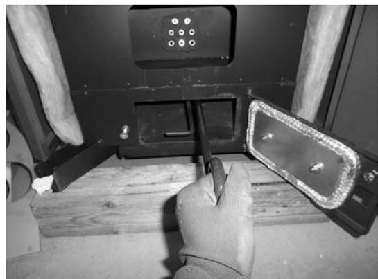
Faire un mouvement pour nettoyer les parois en allant d'un angle à l'autre de la chambre de combustion.
