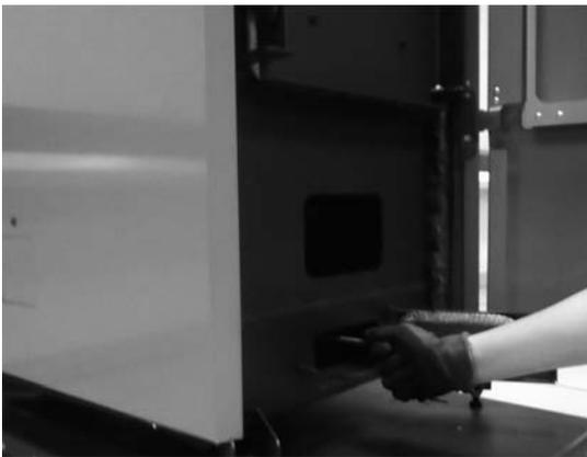
A l'aide de l'outil prévu à cet effet, nettoyer l'intérieur de la chambre de combustion. Pour cela, introduire l'outil à l'horizontal.
