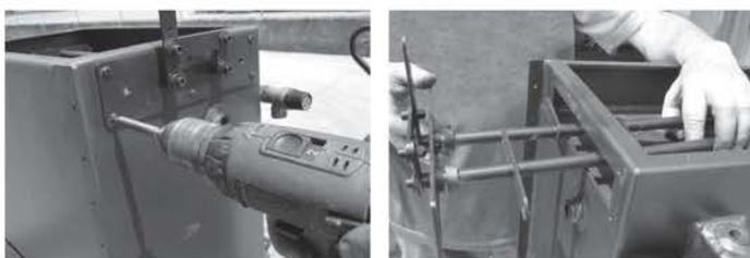
A la suite du nettoyage du compartiment supérieur de la section d'échange, stocker le couvercle de fermeture supérieur. Ce couvercle doit être fermé, ainsi que par des vis normales, avec des sangles à la corde en fibres céramiques pour assurer la fermeture étanche de l'hydropoêle.
