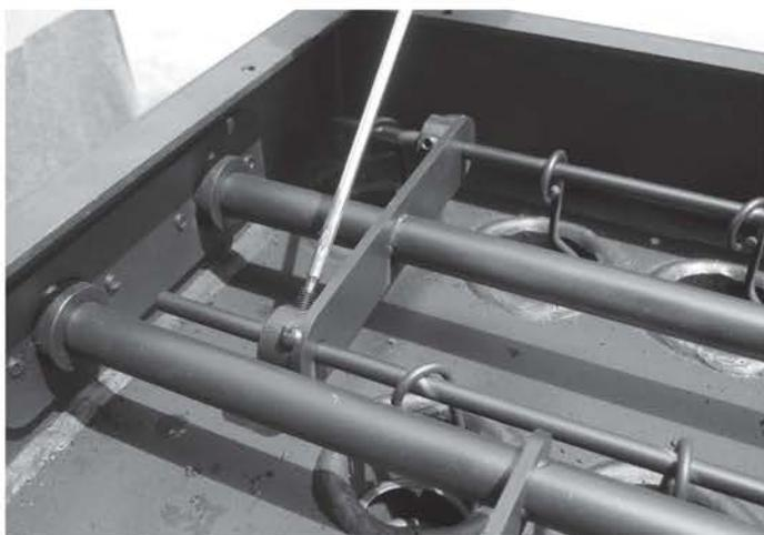
L'opération peut être réalisée avec un tournevis en enlevant la paroi de l'hydropoêle et la suppression de tous les joints horizontaux.
