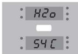
Pour régler la température de l'eau, appuyer une seule fois sur le bouton . Le message "SET H20" s'affichera de manière alternée sur l'écran supérieur et la température de l'eau sera visualisée sur l'écran inférieur.
