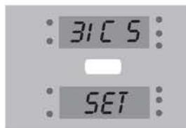
Dans le cas présenté à côté, le ventilateur d'air chaud fonctionne à la vitesse 5, le maximum possible.
