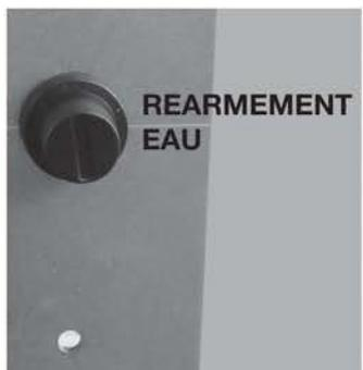
**Thermostat de sécurité à réarmement manuel pour la température de l'eau:** si la température de l'eau dépasse le niveau de sécurité programmée à 100°C arrête immédiatement le fonctionnement de l'appareil et l'écran affiche "ALAR-SIC-FAIL". Pour redémarrer, vous devez réinitialiser le thermostat manuellement.
