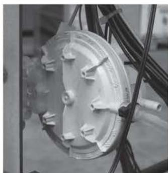
**Pressostat fumées:** il contrôle la pression dans le conduit de fumée. Il sert à bloquer la vis sans fin au cas où la sortie de fumées serait bouchée et en cas de contre-pressions importantes par exemple en présence de vent.
