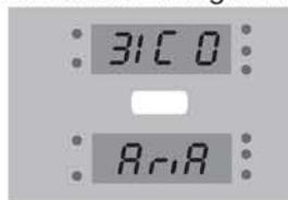
Dans le cas présenté à côté, le ventilateur d'air chaud est éteint. En effet, la vitesse est configurée à "0".
