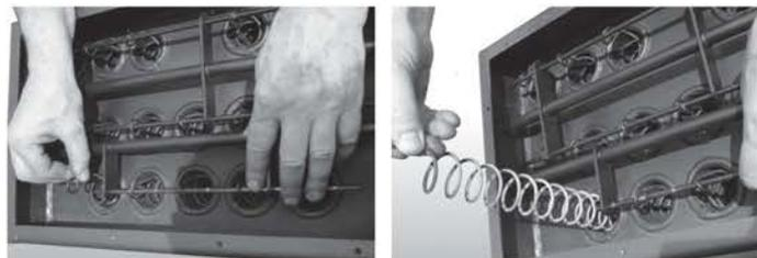
Pour faciliter le processus, la jonction peut faire défiler horizontalement et tirez grâce à un trou dans la paroi du corps de l'hydropoêle.
