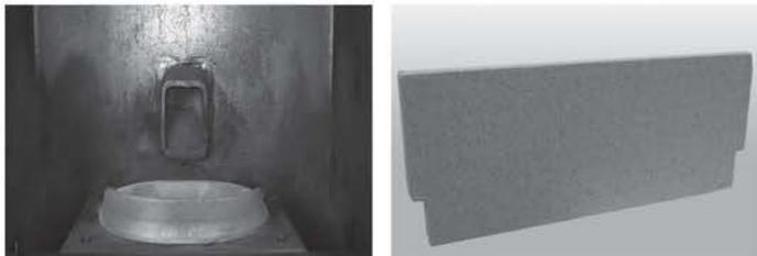
La vermiculite est un minéral à partir d'une variété d'utilisations dans l'industrie et construction pour ses propriétés d'isolation thermique et acoustique. Dans ce cas, la vermiculite est utilisé pour éviter les dispersions thermiques inutiles.
